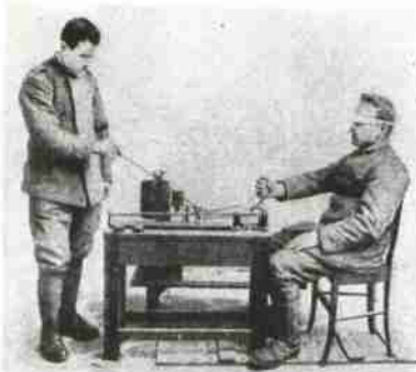
Erpoestesiógrafo de Galeotti para el examen del sentido muscular adaptado á la actividades aeronáuticas. Tomada de Amedeo Hertlička, Fisiología ed Aviazione.
